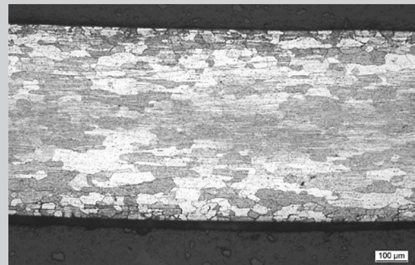
Bild 2: Gefüge PtAu5-XRS nach 10h / 1000°C
